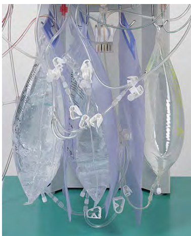
Fig. 5-12 Collegamento delle linee buffer e ultrafiltrato
