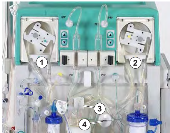
Fig. 5-9 Installazione degli spezzoni pompa
